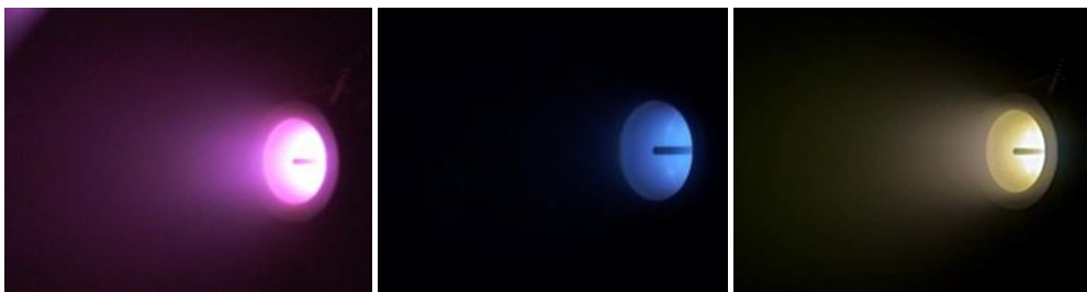
Figure 1 : Propulseur ECRA en fonctionnement, de gauche à droite, avec de l'azote, du xénon et de l'iode.
