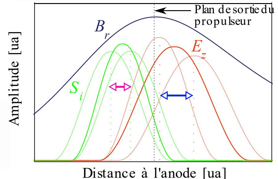
Déformation de la FDI due aux oscillations du temps de transit des ions :
