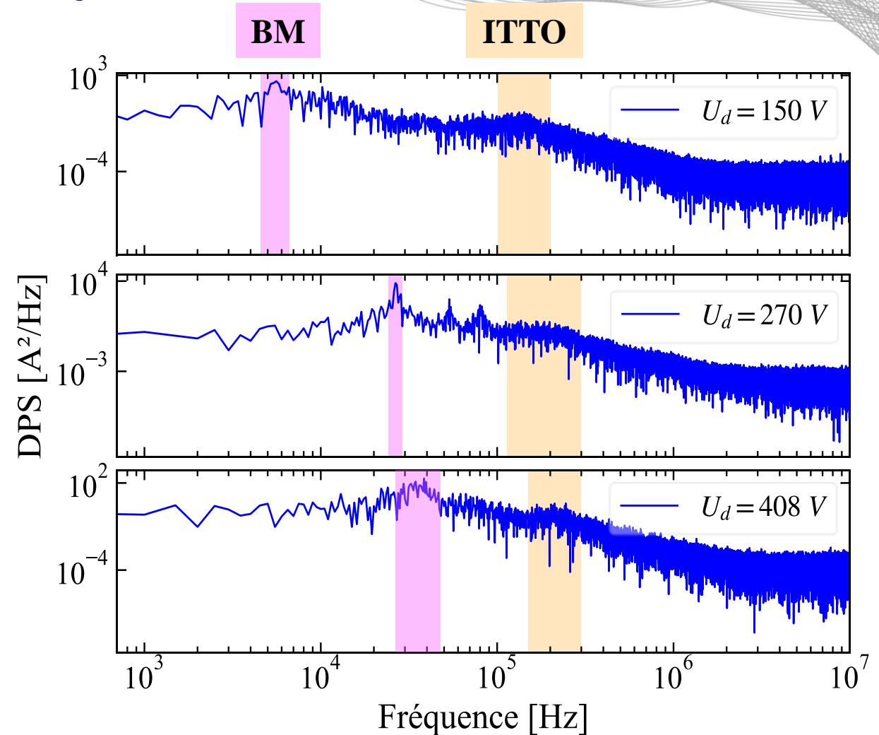
→ La non périodicité des oscillations est une limite du calcul des spectre de Fourier, à la place nous pouvons effectuer une analyse temps-fréquence.
